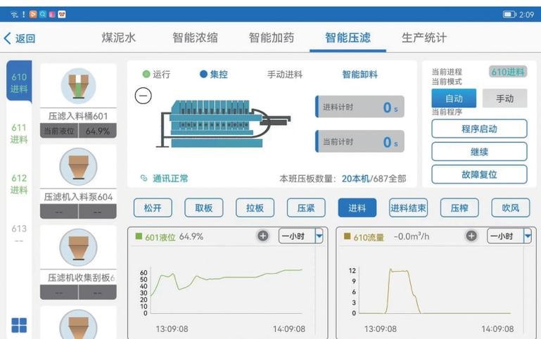
图4 智能压滤检测系统控制界面
